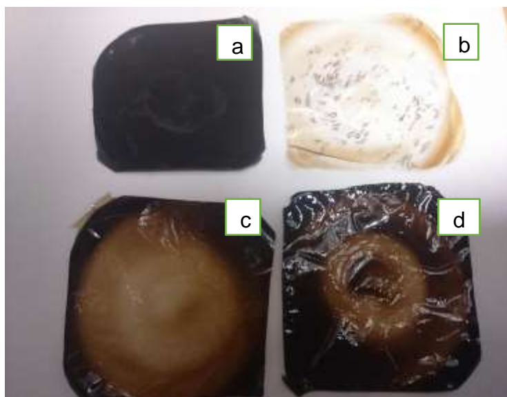
Figure 5.2: Recast membranes (a) Commercial PdNps/Nafion ® (b) PdEG11/Nafion ® (c) PdEG22/Nafion ® and (d) PdEG33/Nafion ® .
