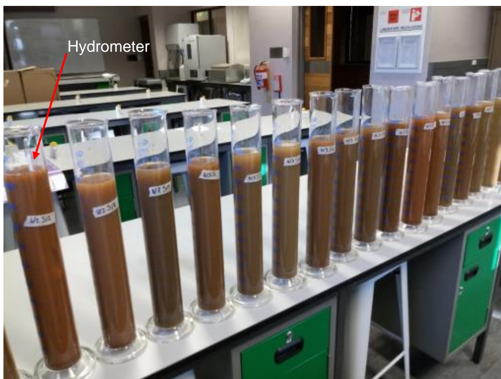
Figure 3.5: Soil texture experiment using hydrometer (Kullander, E., Roodepoort, December 2019)
