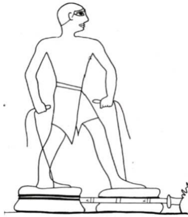
Fig. 4.3 Draagbare blaasbalk funksioneer met gebruik van voete 65
